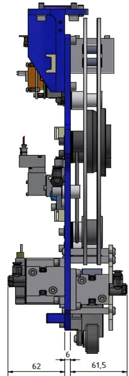
Die Abbildung zeigt den Roboterflansch für Universal Robot, dieser kann aber für andere Robotertypen angepasst werden.
