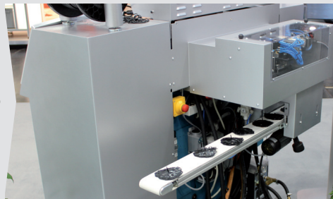
Kompaktes Entnahmehandling mit Teileabtransport auf der Maschinenrückseite
