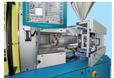
Die ausschwenkbare Spritzeinheit erleichtert Umrüstungen und Wartungsarbeiten
