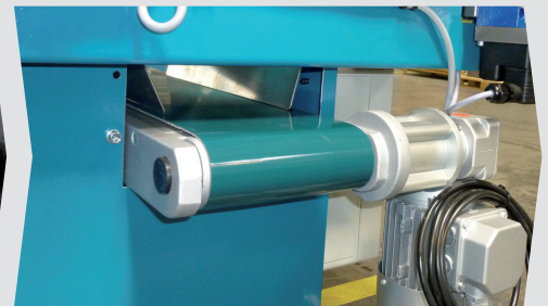
In den Ausfallschacht der BOY 25 E integriertes Sortierförderband als Option
