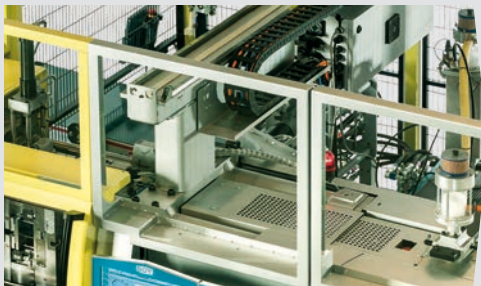
Montage des BOY-Handlings LR5 auf der Spritzgießmaschine
