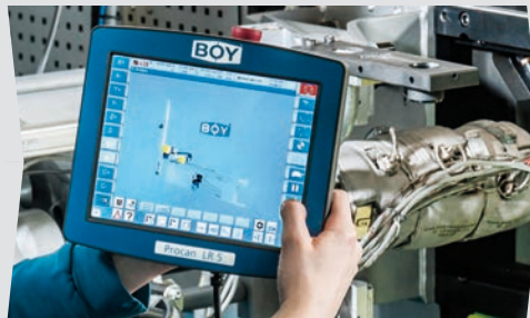
10" Terminal mit kabelgebundenem Not-Halt und Zustimmung-(Totmann-)Taster
