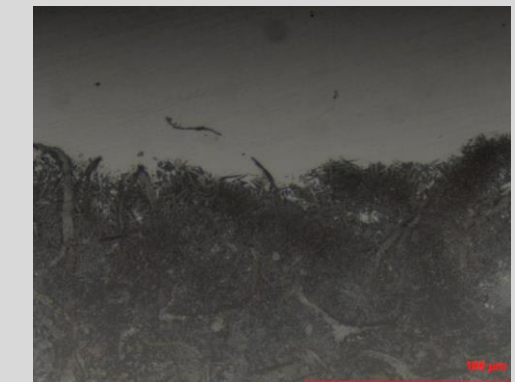
Schliffbild geätzt, V 500, Martensitbildung
