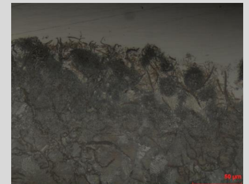
Schliffbild geätzt, V 500, Martensitbildung
