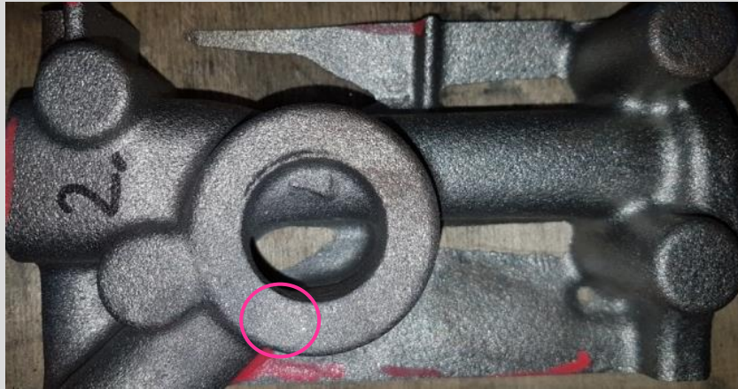
Geschweißte Fehlstelle Wandstärke ca. 12 mm
