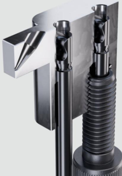
HeiNo®-Tunnelanguss mit Überlaufentlüftungseinsatz
