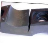
Bild 2: Vermeidbare Produktfehler „Bauteilverrängen“
